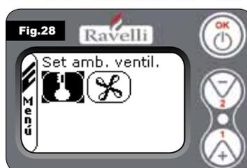
Dallo stato di fig. 15-A (par.7.2) per accedere al MENU UTENTE premere il pulsante OK per 2 volte. Per accedere al MENU VENTILAZIONE premere per 7 volte il tasto 2 e confermare con OK. Per selezionare il tipo di funzione utilizzare i tasti 1 e 2 e confermare con il tasto OK.
